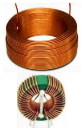
**Grandeurs associées à une bobine** : résistance interne  $r$  (le fil de cuivre possède une résistance car il est long) et auto-inductance  $L$ , dont l'unité est le Henry, H. Exemple : une bobine possède une auto-inductance  $L = 0,1$  H et une résistance interne  $r = 2 \Omega$ .
