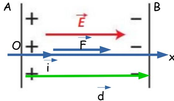
La force électrostatique a donc pour expression, avec une particule possédant 2 charges positives,  $\vec{F}_e = q \times \vec{E} = 2 \times e \times \vec{E} = 2 \times e \times \frac{U_{AB}}{d} \vec{i}$ .
