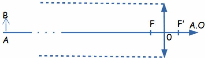
L'objet est de plus en plus loin de la lentille : les rayons issus de B et arrivant sur la lentille sont de plus en plus parallèles entre eux.
