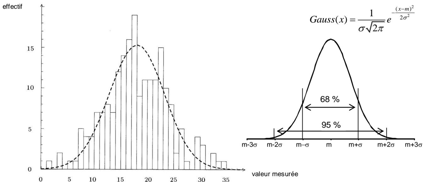
La loi normale n'est caractérisée que par deux paramètres  $m$  et  $\sigma$  appelés respectivement *moyenne* (indiquant la valeur centrale) et *écart-type* (indiquant la largeur de la courbe).
